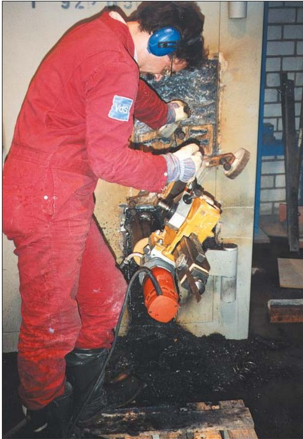
Prüfmethode mit einem Diamantkronenbohrer
