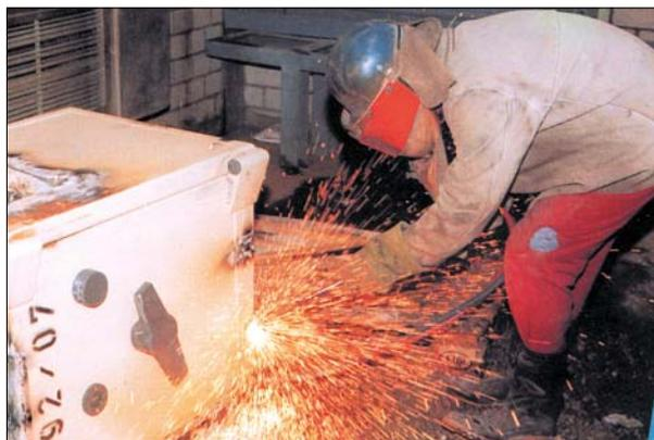
*Prüfmethode mit einem Schneidbrenner*
