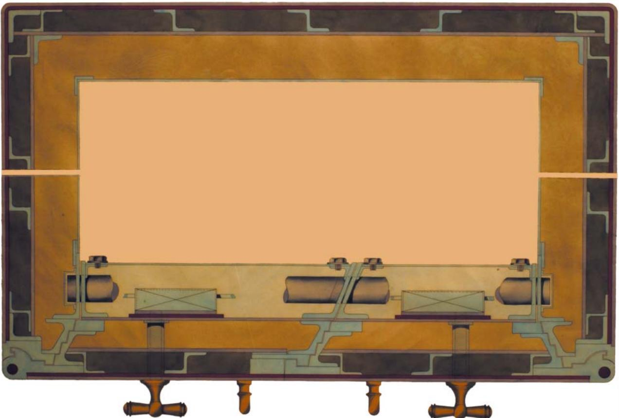
*Querschnitt durch einen Tresor*
