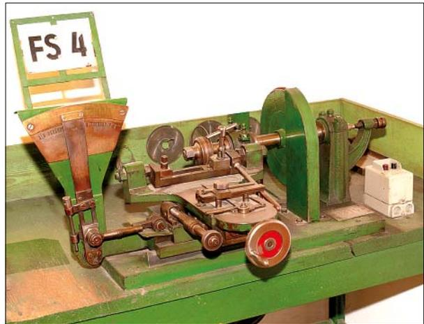
*Schlüssel-Fräsmaschine für Doppelbartschlüssel*
