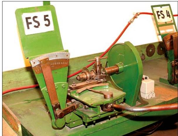
*Schlüssel-Fräsmaschine für Stecherschlüssel*
