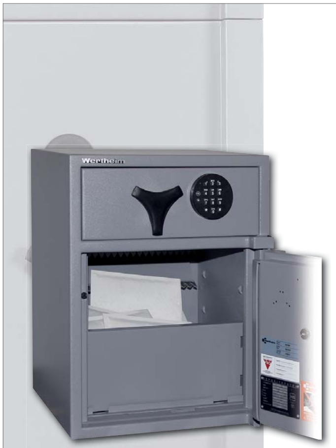
Abb. Deposit-Wertschutzschrank AG15DF - Lade vorne, K-Schloss Cawi 2 Schlüssel (95 mm), Ladensperre: E-Schloss M-Locks EM2020 Schwenkriegel, Option: 1 Rückhalteblech
