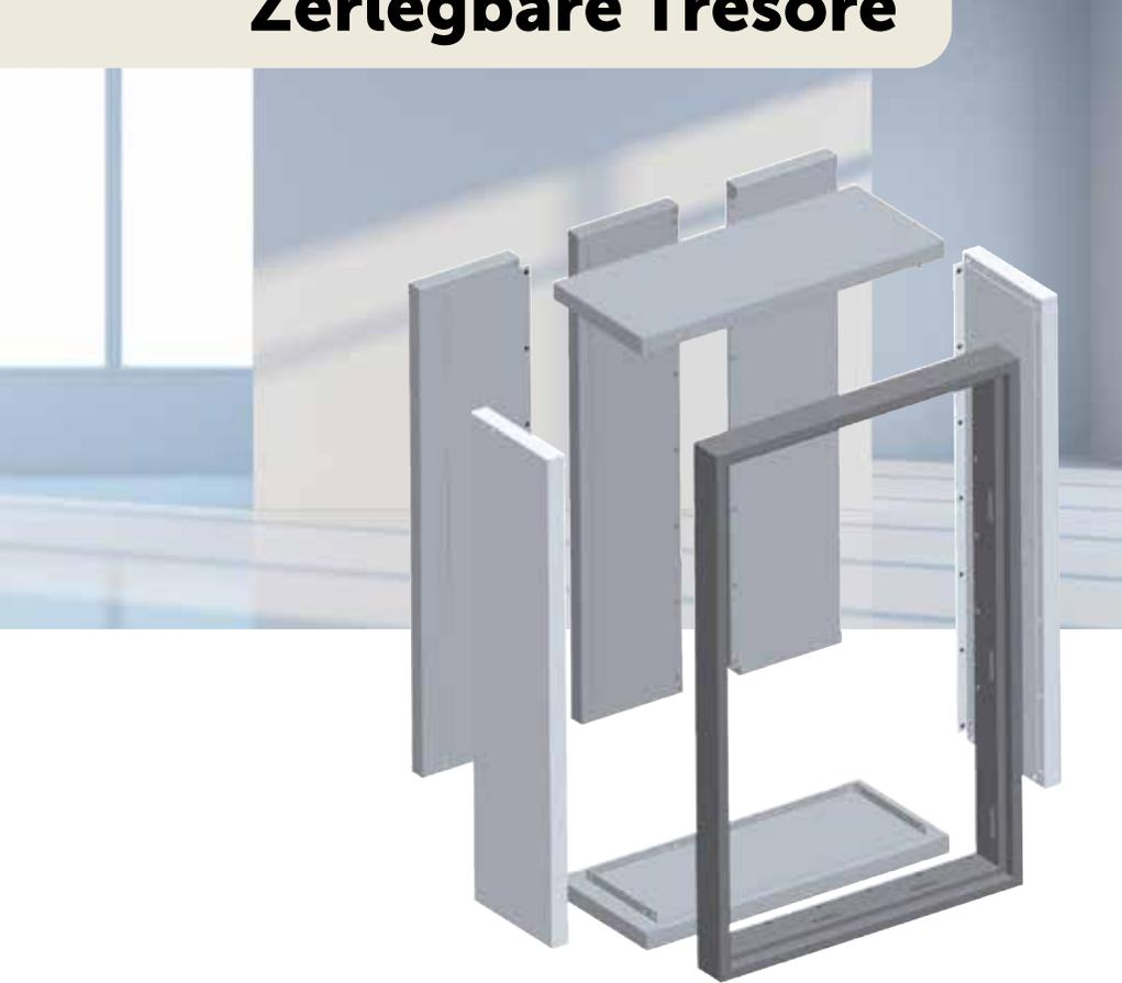
Tresore in zerlegbarer Ausführung werden in den Widerstandsgraden IV(KB) und V(KB) angeboten. Sie kommen bei schwierigen Transport- und Einbringungssituationen zum Einsatz. Die Schränke werden in Elementen gefertigt und geliefert. Der Zusammenbau erfolgt bauseits am Aufstellort durch Verschrauben.
